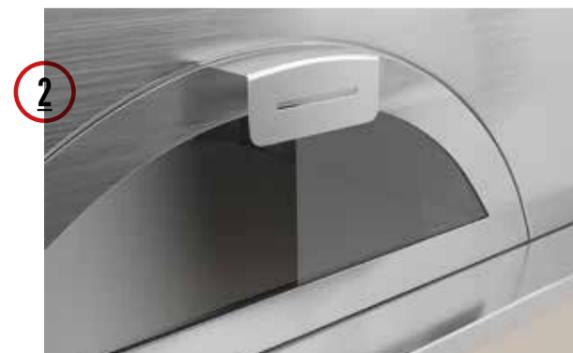
**2.** Pratico vetro di ispezione delle fasi di cottura montato sulla porta fuoco: realizzata in vetro ceramico resistente oltre 800°C, la finestra di ispezione sulla porta fuoco, permette il costante controllo delle fasi di cottura senza la necessità di aprire la stessa, conservando più uniformemente il calore all'interno del forno e consumando meno legna.
